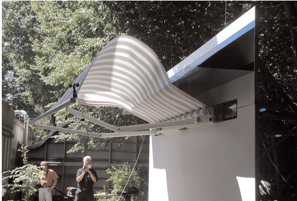
Abb. 2: Beispielhaftes Verhalten einer Markise im Windkanal zu Energieabsorption
