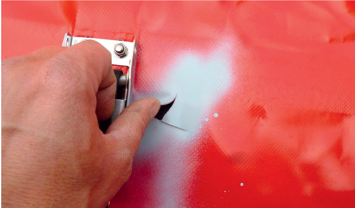
Schaden nach unsachgemäßer Instandsetzung
