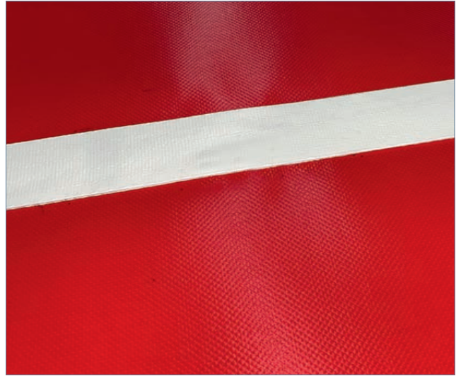
Nach sachgemäßer Instandsetzung Reparaturmaterial im Zuschnitt
